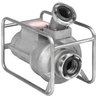
Einstufige Kanalradpumpe aus meerwasserbeständiger Aluminiumlegierung nach DIN EN 1706, verschleißfestes Laufrad aus Sonderguss-eisen nach DIN EN 1563, Schrauben aus Edelstahl. Mit B-Storz Kupplungen, vollüberflutbar. B-Abgang 45 Grad drehbar. Wassertemperatur bis 60 °C. Stark
